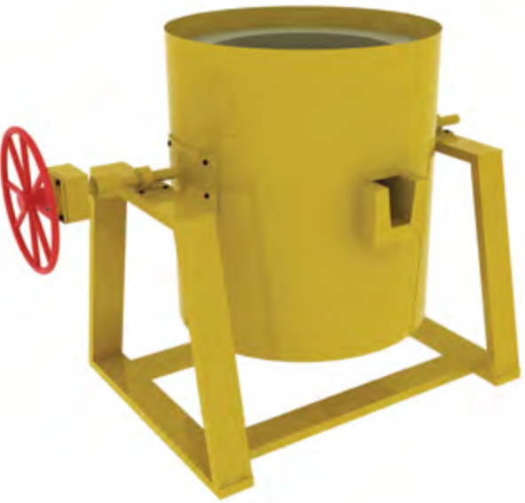
Fotografía 17: Modelo de horno con crisol. Fuente: Propia.
