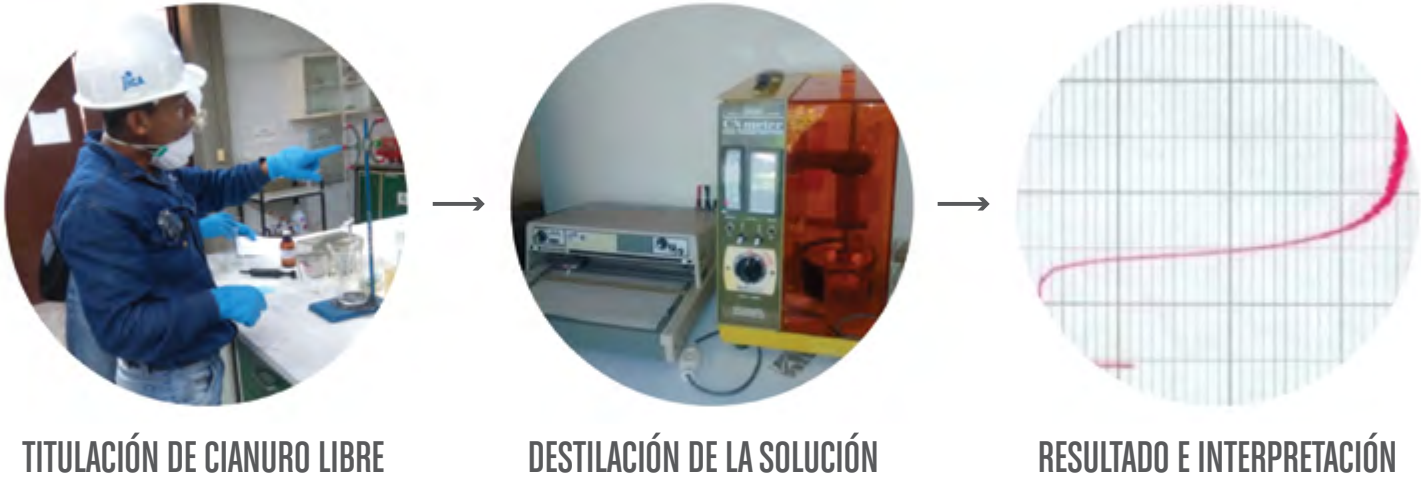
Figura 6.4: Determinación de cianuro total en una solución residual. Fuente: Propia.
