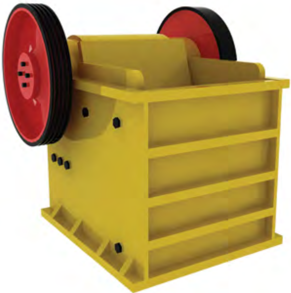
Fotografía 5: Modelo de trituradora de quijadas. Fuente: Propia..
