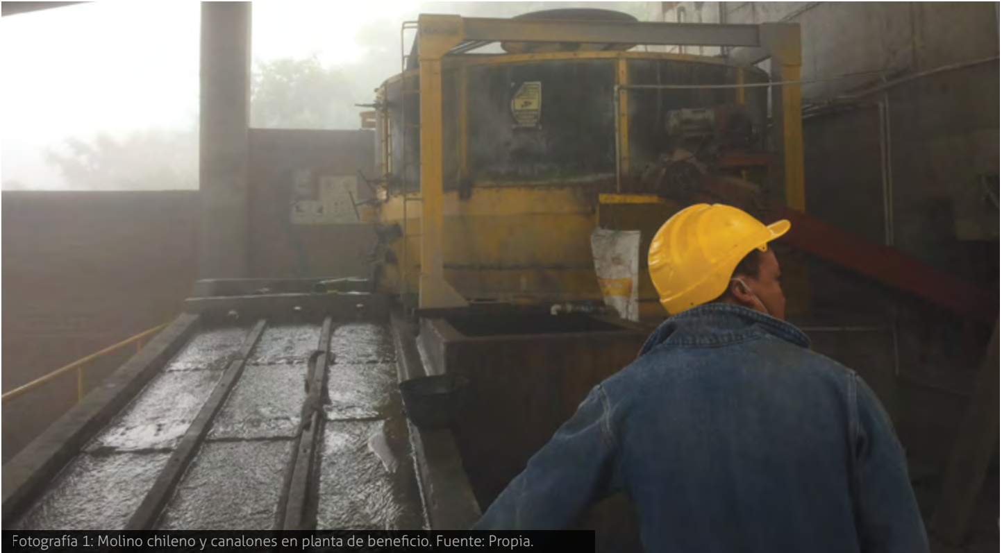
Fotografía 1: Molino chileno y canalones en planta de beneficio. Fuente: Propia.
