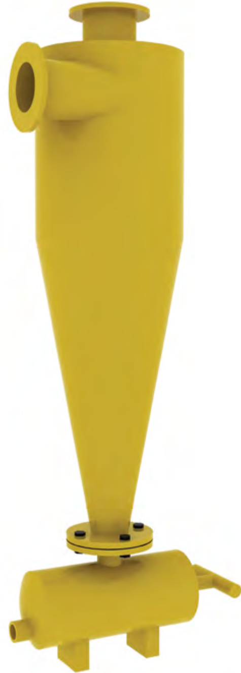
Fotografía 10: Modelo de hidrociclón. Fuente: Propia.
