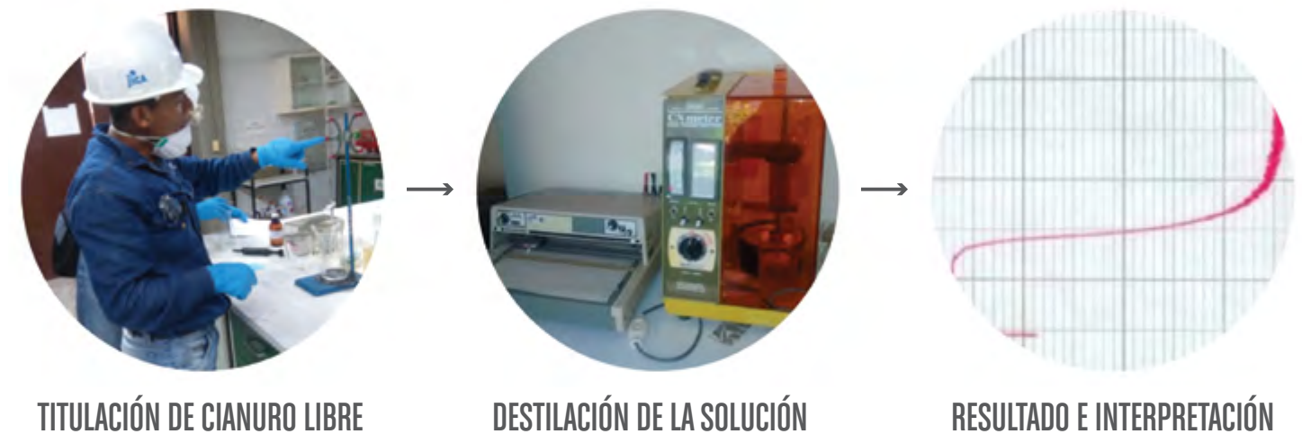
Figura 6.3: Determinación de cianuro total en una solución residual. Fuente: Propia.
